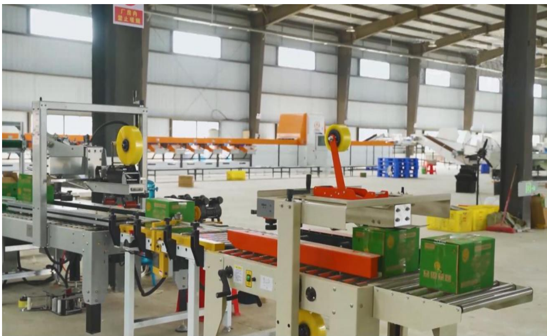
图2 智能包装生产线进行装果及开、封箱作业图
