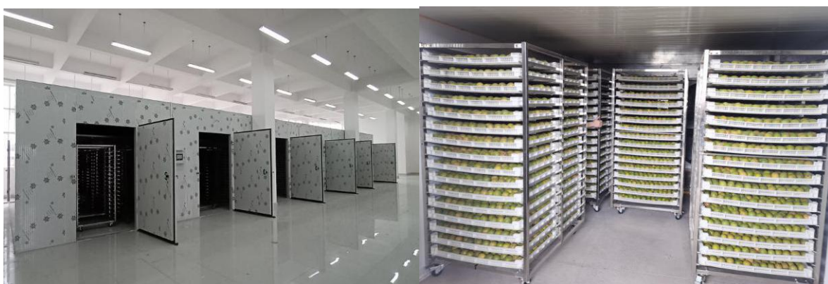
图 7 自动化控温控湿烘烤设备
