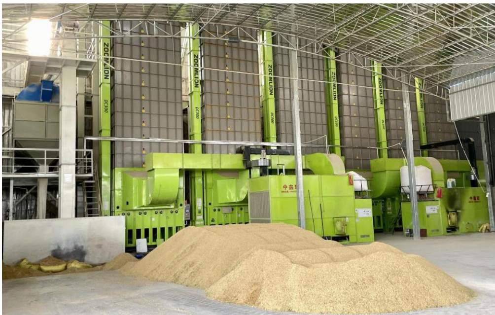
图1 低温循环烘干机进行烘干作业
