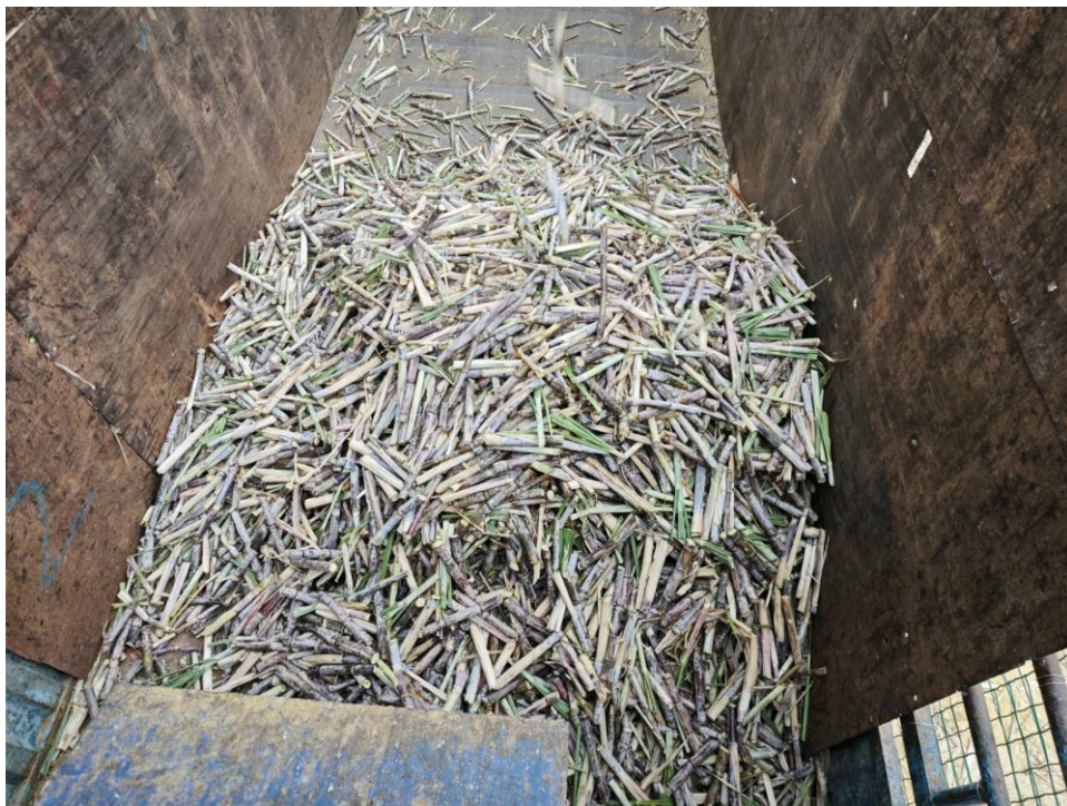
图 3 糖料蔗除杂设备除杂切断后的糖料蔗
