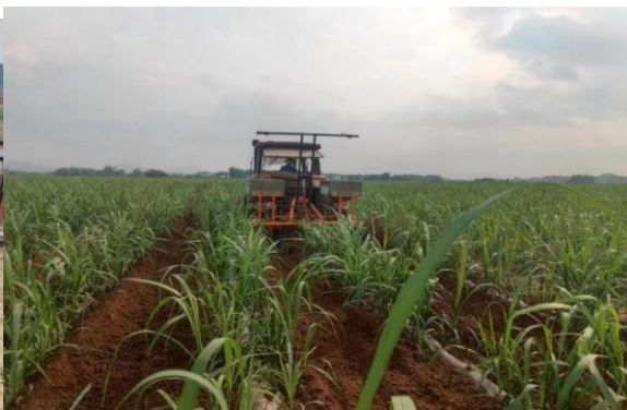
图 甘蔗中耕培土机正在作业
