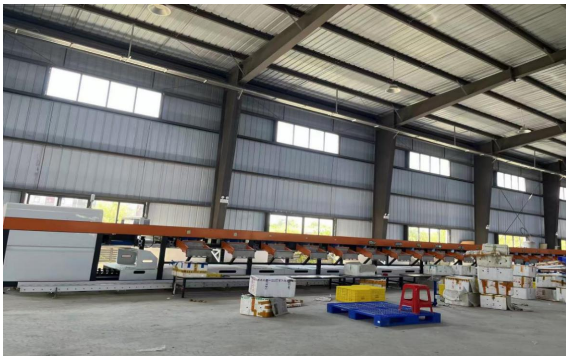
图 1 水果清洗、打蜡、自动化分选分级生产线
