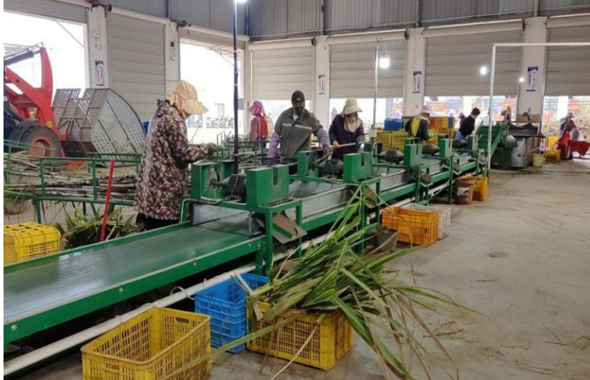
图 4：脱毒蔗种流水线
