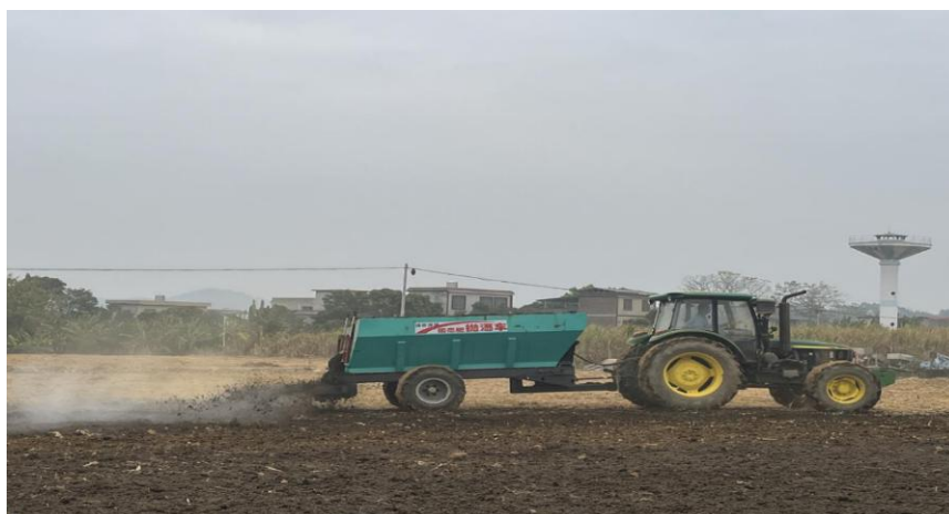
图 有机肥抛洒车正在作业
